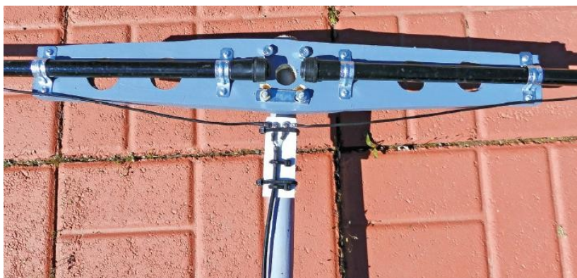
Foto 1.1.4.4. Izolátory spojující konce chladiče a reflektoru Foto 1.1.4.5. Připojení chladiče
