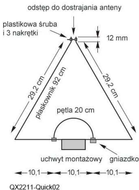
Obr. 4.3.1. Trojúhelníková smyčková anténa o délce 2 m s napájecí smyčkou Obr. 4.3.2. Rozměry antény
