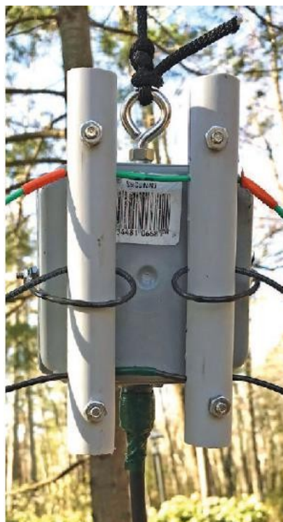
Foto 1.1.5.3. Spojovací skříňka se symetrizačními prvky a dvěma vzpěrami z PVC
