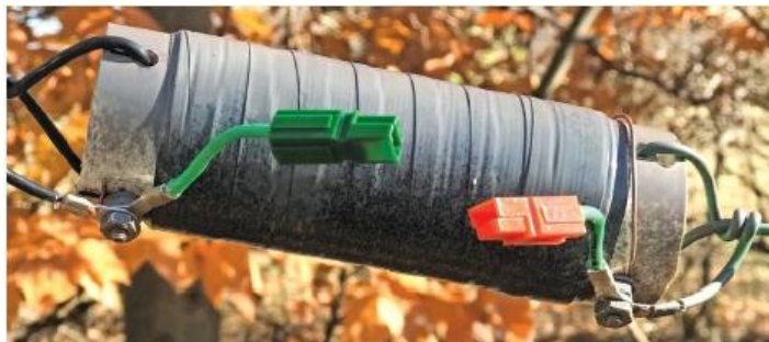
Foto 1.1.5.5. Prodlužovací cívka pro pásmo 80 m bez připojeného můstku. Cívka je omotána izolační páskou, která stabilizuje vinutí a chrání jej před vlivy prostředí. Cívka byla z estetických důvodů natřena šedou barvou. Vpravo je vodič pro pásmo 80 m a vlevo je hlavní část dipólu pro pásmo 40 m. Foto 1.1.5.6. Pohled na vzpěru pro tři dráty
