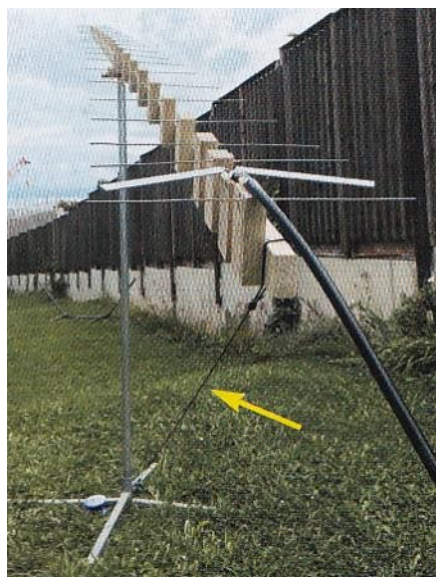
Obr. 4.1.4. Dokončená anténa a způsob nastavení směru
