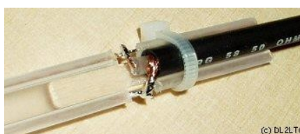
Obr. 4.2.7. Možný způsob zajištění mezery teplem smrštitelným pláštěm Obr. 4.2.8. Možný způsob zajištění kabelu na konci antény.
