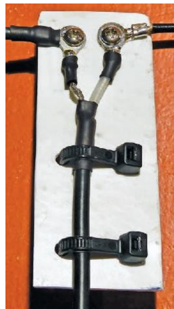
Foto 1.1.4.2. Upevnění konců tyčí na desky Foto 1.1.4.3. Způsob výroby svorek
