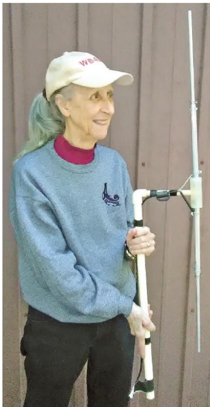
Foto 4.4.1. Pohled na anténu ve vertikální polarizaci Obr. 4.4.3 Konstrukční detaily. Centrální izolátor z HDPE
