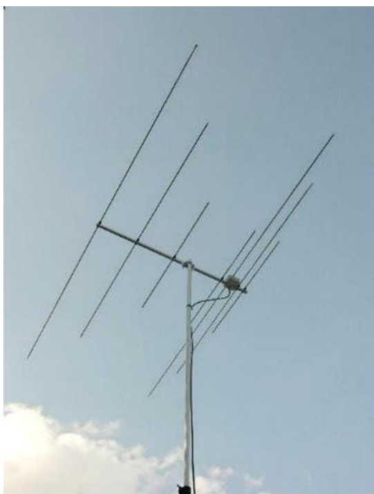
Foto 3.1.1. Pohled na třípásmovou anténu
