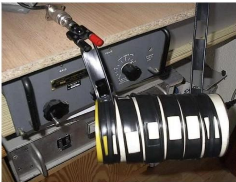
Foto 1.1.2.2. Symetrizační zařízení pro ploché kabely. Na obrázku připojený k měřicímu systému
