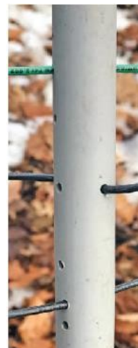
Foto 1.1.5.5. Prodlužovací cívka pro pásmo 80 m bez připojeného můstku. Cívka je omotána izolační páskou, která stabilizuje vinutí a chrání jej před vlivy prostředí. Cívka byla z estetických důvodů natřena šedou barvou. Vpravo je vodič pro pásmo 80 m a vlevo je hlavní část dipólu pro pásmo 40 m. Foto 1.1.5.6. Pohled na vzpěru pro tři dráty
