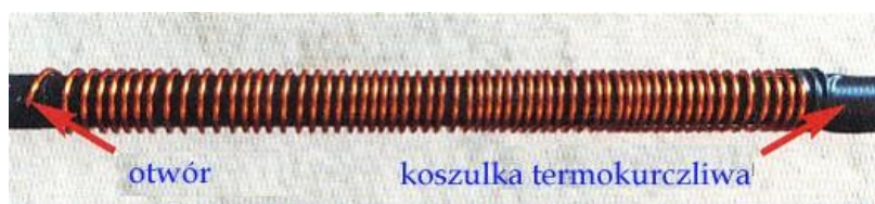
Obr. 1.2.2 Sestava cívky a přívodu. Vlevo je vidět otvor do vnitřní části trubky a vlevo způsob ochrany smršťovací bužírkou.
