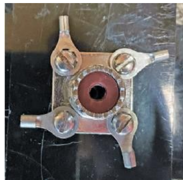
Foto 1.2.7.3. Prodłużovací cívky pro 30m pásmo před impregnací a instalací Foto 1.2.7.4. Koaxiální zásuvka je upevněna pod křížením plochých tyčí.
