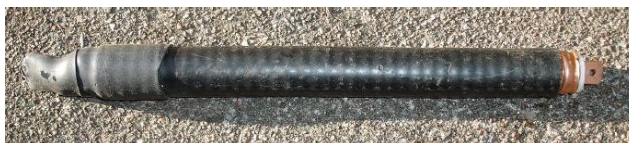
Foto 1.2.9.2 Tlumivka se skládá z 27 cívek koaxiálního kabelu navinutých na PVC trubce o průměru ~11 cm.
