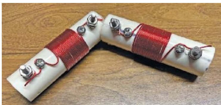
Foto 1.2.7.3. Prodłużovací cívky pro 30m pásmo před impregnací a instalací Foto 1.2.7.4. Koaxiální zásuvka je upevněna pod křížením plochých tyčí.
