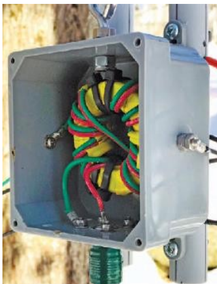
Foto 1.1.5.3. Spojovací skříňka se symetrizačními prvky a dvěma vzpěrami z PVC
