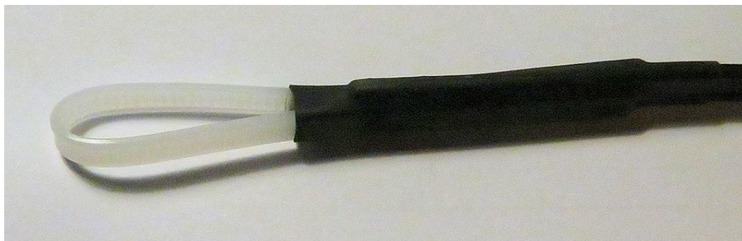
Foto 4.2.6. Smyčka v horní části antény pro zavěšení antény
