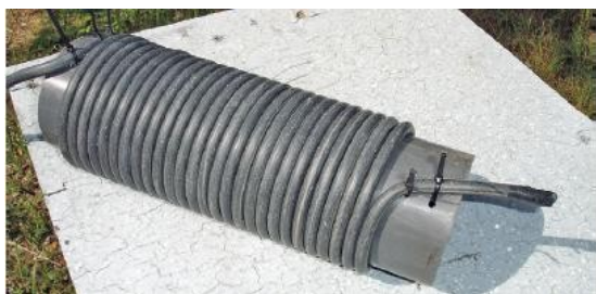
Foto 1.2.9.2 Tlumivka se skládá z 27 cívek koaxiálního kabelu navinutých na PVC trubce o průměru ~11 cm.
