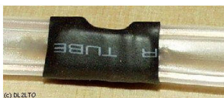
Obr. 4.2.7. Možný způsob zajištění mezery teplem smrštitelným pláštěm Obr. 4.2.8. Možný způsob zajištění kabelu na konci antény.
