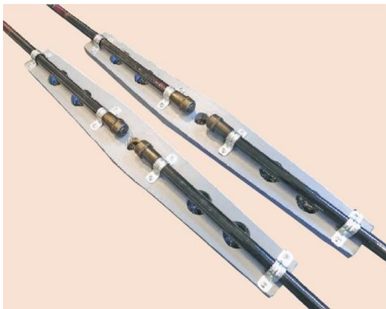
Foto 1.1.4.2. Upevnění konců tyčí na desky Foto 1.1.4.3. Způsob výroby svorek
